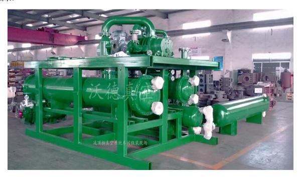
关于水环罗茨真空机组真空系统设计需要注意的几个问题您了解多少?关于这一点让我们看一下淄博华中真空设备有限公司为我们做一下介绍。【水环罗茨真空机组设计需要注意的问题】1、真空泄漏:在选定水环罗茨真空机组的抽速時,要考虑到真空系统都存在一定量的空气泄漏。过量的泄漏会降低真空泵对工艺气体的抽速,这种泄漏都是发生在真空管道的連接处和真空容器的連接处。2、判断是水环罗茨真空机组问题还是系统问题:为了做出正确的判断,可以在泵的入口阀门关闭的情下,测量真空泵的极限压力,如果测得的极限压力很接近制造厂给出的数据,表明问题來自于系统的漏气和放气3、过高的排气压力与背压水环罗茨真空机组的排气压力是一个大气压或稍为高于大气的压力,当排气压力高于一个大气压时就会造成:(1)泵的温度升高以及由于过热而造成泵被卡死。(2)泵在运行時的电流升高,造成电机过载、跳闸等故障。4、吸气口和排气口管路尺寸的选择为了消除真空管路对真空泵性能的影响,可以根据下列原则考虑:(1)連接真空泵的吸气口和排气口的管路尺寸不能小于吸气口和排气口的尺寸。(2)为了弥补因真空管道长度而造成对真空泵抽速的影响,吸气口
