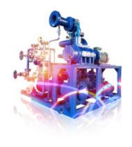
如何每天维护?许多人可能操作罗茨鼓风机,但不知道如何维护它。事实上,罗茨真空泵的维护是一个与您分享的小技巧。必须定期检查罗茨真空泵检查分为日常检查,月检和半年检查。日常检查项目主要有:油位检查:油量过多,使温度升高,油量过少,导致润滑不良;温度检查:用温度计检查泵各部分的温度;检查电机负载:用功率计或电流,电压表测量电机负载。每月检查联轴器和垫圈是否有损坏和松动。三个月检查:变速箱中的润滑剂是否会变质?检查罗茨真空泵活塞环和活塞环衬套半年;齿轮的轻微磨损是否影响转子的正常运转,是否需要调整;前盖轴承箱内的润滑油是否劣化。如果在检查中遇到问题,则问题及时得到解决。如果罗茨真空泵问题太大,比较好联系工程师进行维护和调整。公司拥有丰富的生产经验和众多的工程技术人员。它质量和售后都很完美。欢迎咨询广东粉丝协会。
